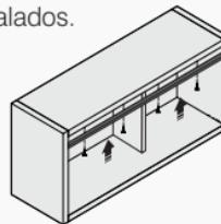
**5 PASSO** Fixar o guia inferior no centro do móvel com parafuso 3,0 x 14 CC.
