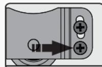
Obs: Após a regulagem, colocar o parafuso de travamento.
